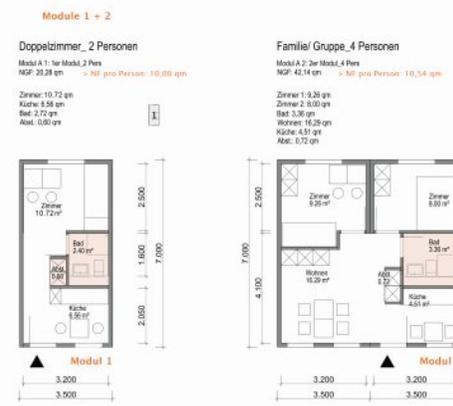
Grundriss Module 1 + 2; Dohle + Lohse Architekten GmbH
